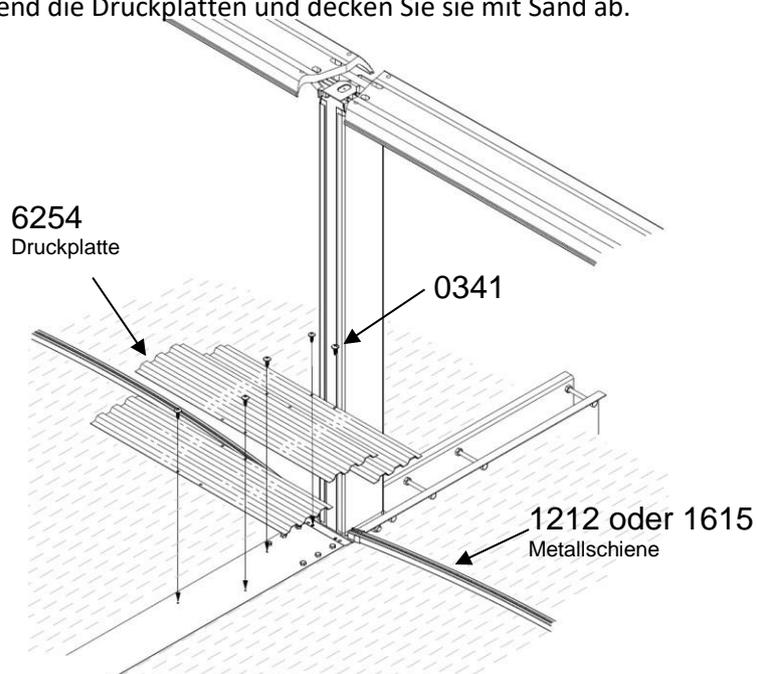
Stimmt die Ausrichtung, stellen Sie sicher, dass die Diagonalen **übereinstimmen**. Ist alles festgekeilt, können Sie die Gräben mit etwas Sand auffüllen.
