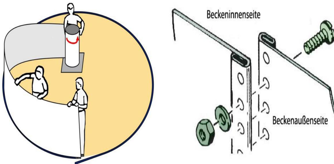
Beenden Sie den Wandkreis und schließen Sie ihn mit den Schrauben, wobei zu beachten ist, dass die Schraubenköpfe sich an der Innenwand- und die Unterlegscheiben und Muttern an der Außenwand befinden. Es ist wichtig, daß jedes Loch der zwei Reihen, mit Ausnahme des letzten, eine Schraube zählt, sonst könnte das Schwimmbad beim Befüllen brechen. Vergewissern Sie sich davon, daß alle untere Profile richtig eingestellt sind. Jetzt dürfen Sie das letzte Profil mit einer
