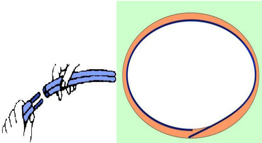
Stellen Sie die Stahlwand des Schwimmbeckens senkrecht auf eine Pappe im Mittelpunkt des Umkreises. Die Wand wird im Uhrzeigersinn auf der ganzen Länge des Kreises vollständig in die inneren Profile abgerollt.
