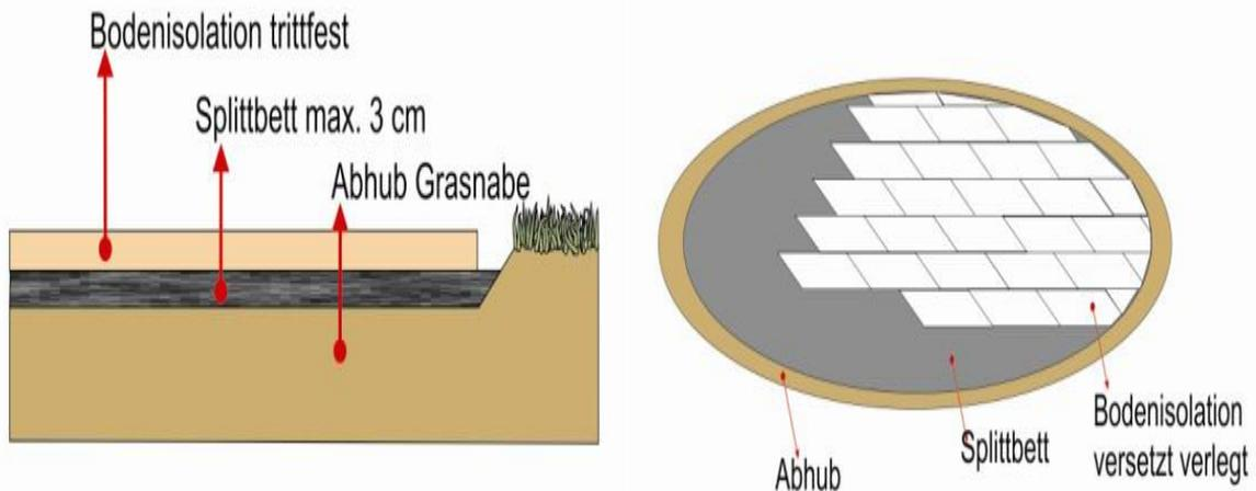
Bei einem Betonfundament gelten die gleichen Anweisungen, wobei die Betonplatte das Splittbett ersetzt (Stärke richtet sich nach den örtlichen Gegebenheiten ca. 15 – 20 cm mit Eisenbewährung)
